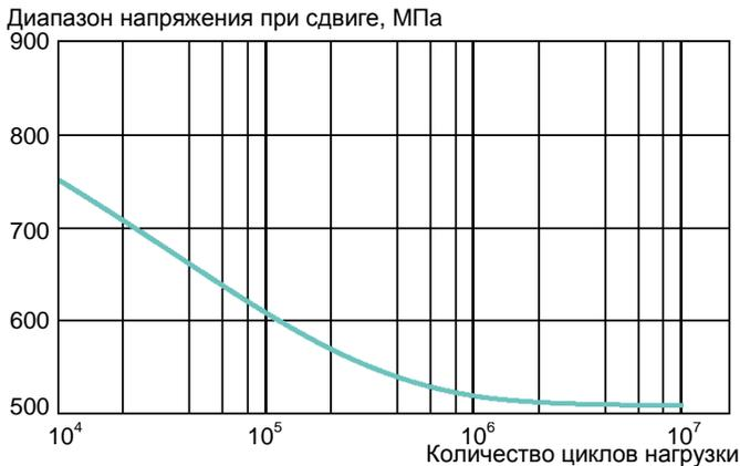
Рис. 3. Кривая действительна для пружин, свитых из проволоки диаметром 1 мм, показывает 90% гарантию от повреждений. Диапазон напряжения при сдвиге = удвоенная амплитуда напряжения. Для достижения 99.9% гарантии от повреждений кривая должна располагаться ниже на расстоянии равном 80 % от настоящих значений.
